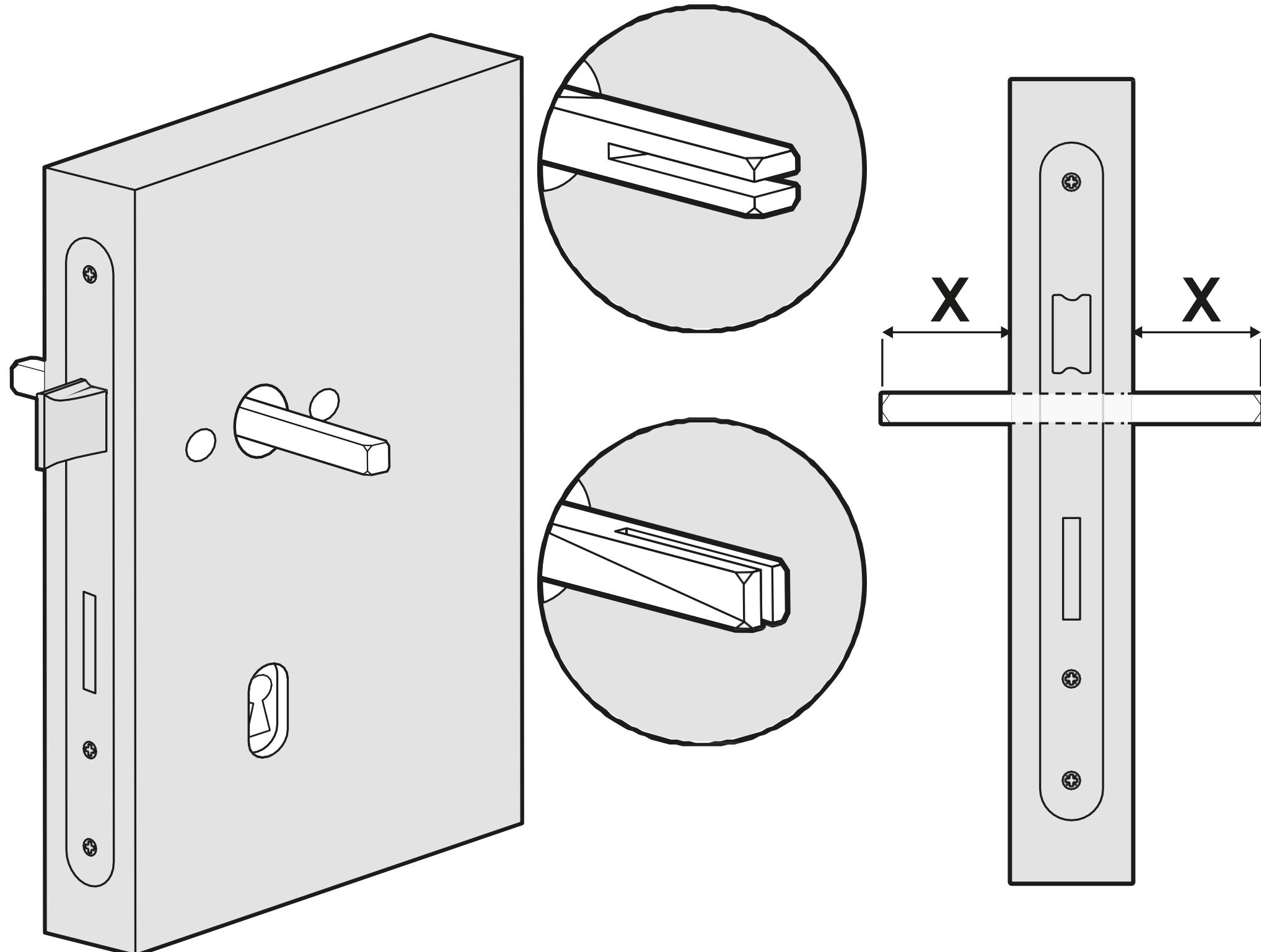
**HU:** Helyezze a négyzetvasat szimmetrikusan a bevészárba ügyelve rá, hogy a rajta lévő kivágás az ajtókilincsben lévő imbuszcsavar felé nézzen.
