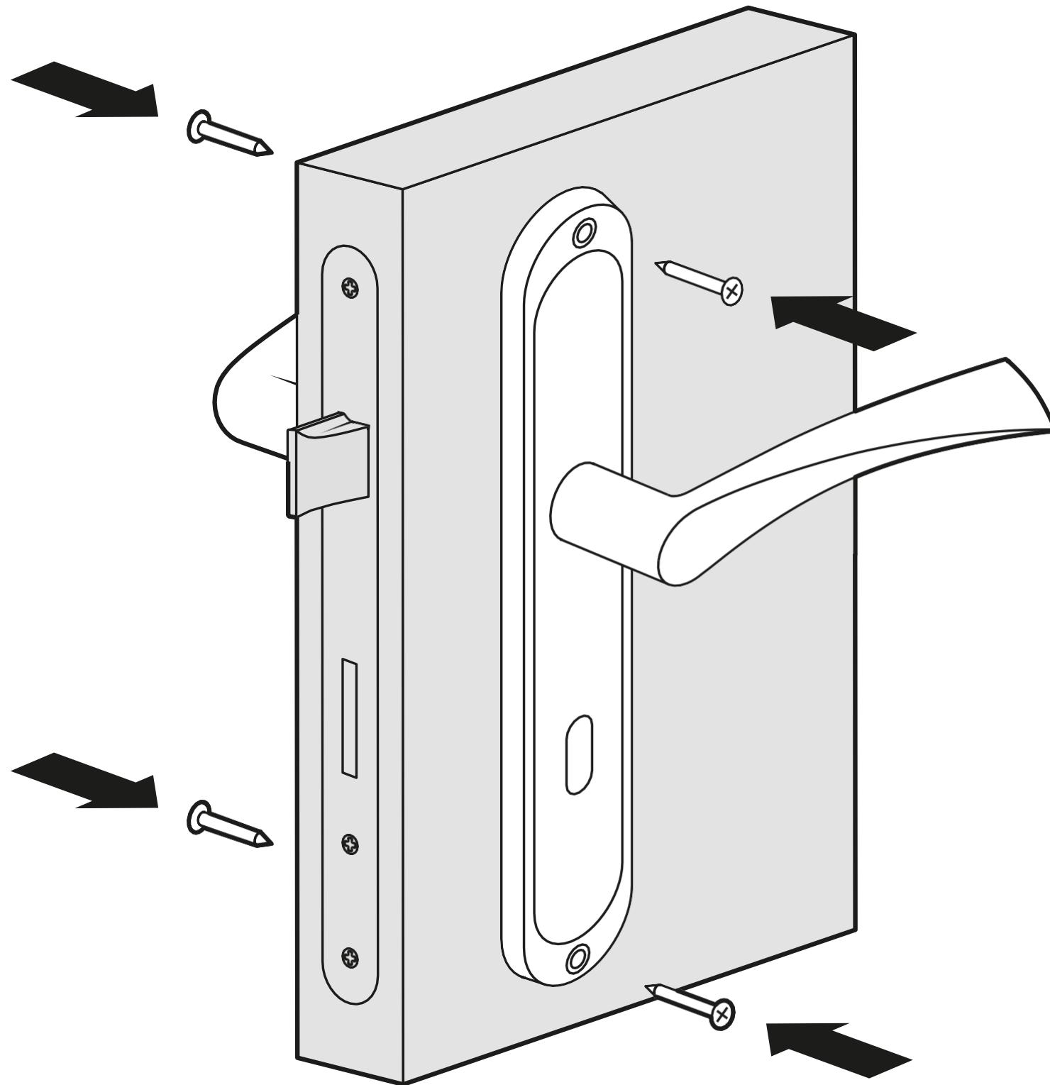
**HU:** A rögzítési tartozékoktól függően rögzítse a két ajtókilincset a mellékelt fa- vagy átmenőcsavarok segítségével (ábra 1.6)
