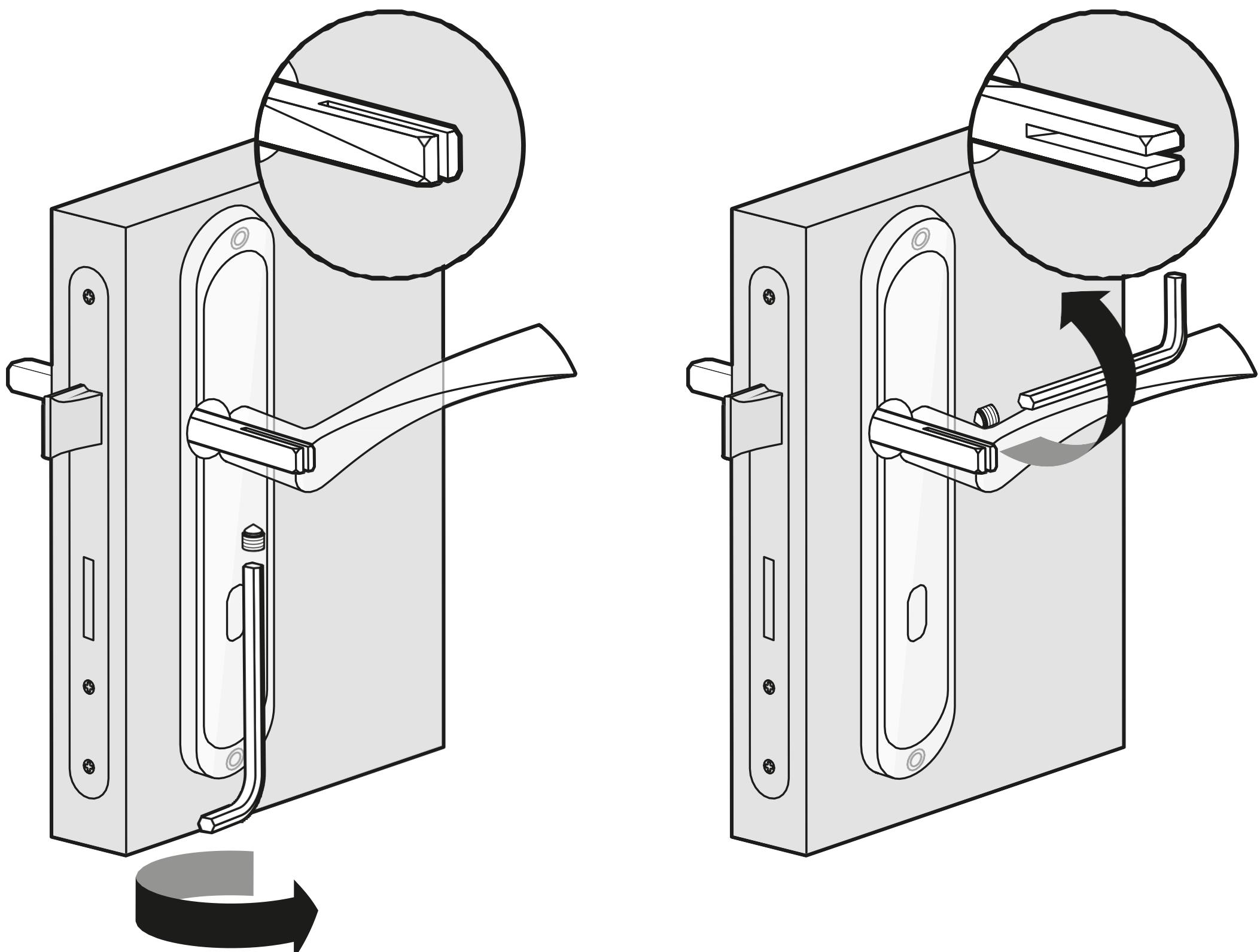
**HU:** Rögzítse a kilincset a mellékelt imbuszcsavarral. Húzza meg erősen az imbuszcsavart alulról vagy oldalról (a kilincs kialakításától függően).
